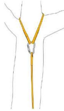
Fig. 5 - Ancoraggio della fune con dispositivo passante
